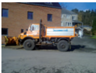
Camion Unimog équipé d'une nouvelle trémie + lame de déneigement
